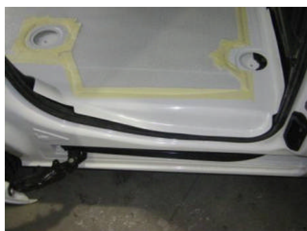
7. REMONTER LE PROFILE EN PLASTIQUE ORIGINAL. POUR UN COUPLMENT MEILLEUR COUPER 5 mm A DROITE ET A GAUCHE
