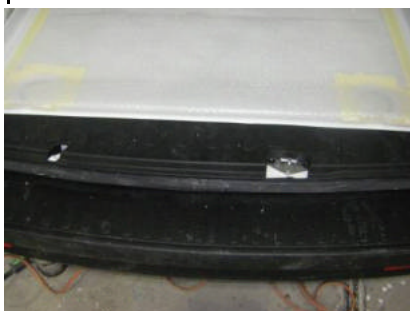
7. REMONTER LE PROFILE EN PLASTIQUE ORIGINAL. POUR UN COUPLMENT MEILLEUR COUPER 5 mm A DROITE ET A GAUCHE
