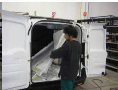
5. AVEC UN LEGERE PRESSION, PLIER LE PLANCHER ET L'INTRODUIRE DANS LE RECEPTACLE
