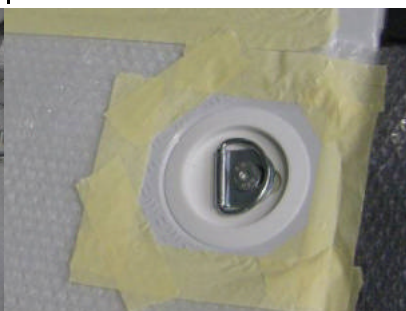
9. POSITIONNER LES COUPELLES ET LES FIXER EN UTILISANT LES BOULONS ET LES CROCHETS ORIGINAUX
