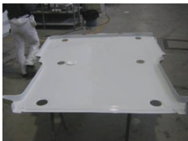
1: PERCER LE PLANCHER EN POLYESTER EN CORRESPONDANCE DES EMPRUNTES (PARTIES LISSES DANS L'ANTIDERAPANT)
