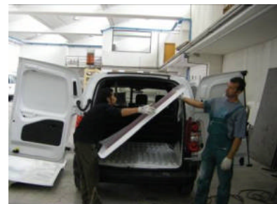
3. INTRODUIRE LE PLANCHER EN POSITION INCLINÉE
