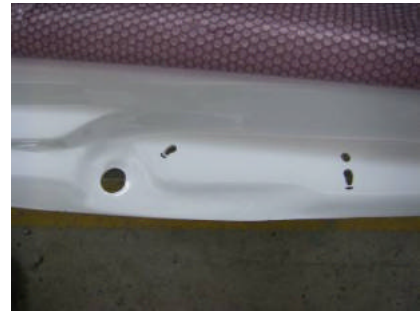
PHOTO 3: REALISER DES TROUS SUR LES EMPREINTES DES BOULONS DE FIXATION CROCHETS DE FERMETURE DES PORTES AR
