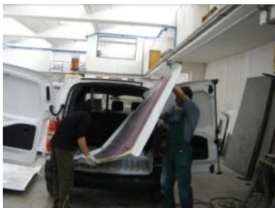
1. INTRODUIRE LE PLANCHER EN POSITION INCLINÉE AVEC LE POINTE ANTÉRIEURE GAUCHE
