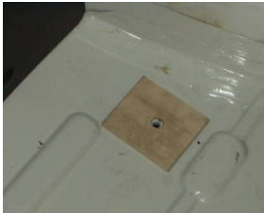
PHOTO 1: CALE EN BOIS POUR LA FIXATION DES CROCHETS DE BLOCAGE DANS SES ANCRAGES ORIGINAUX
