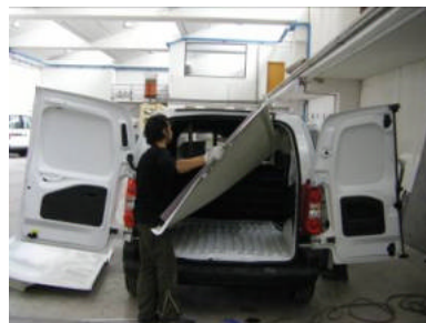
2. AVEC UNE PRESSION FAIBLE FLECHIR LE PLANCHER ET LE POSITIONNER DANS LE RECEPTACLE.
