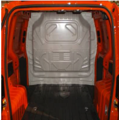
1. CLOISON MÉTALLIQUE FERMÉE
